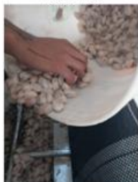
1. Ingreso del cacao en baba a la máquina de fermentación mecánica
